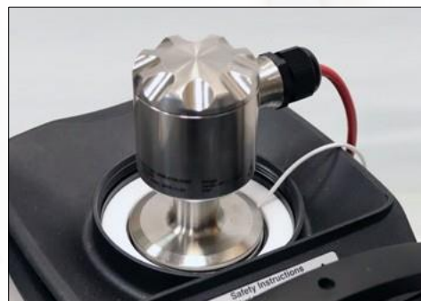
RTC-168和STS-102 A 035外置参考校准卫生型传感器
