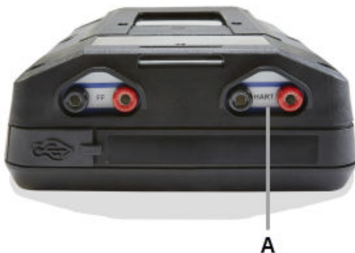
图 3-9: Device Communicator 通讯模块上的 HART 通讯端子
