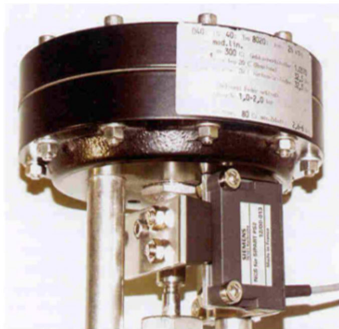
Bild 5: NCS angebaut an Linearantrieb.
