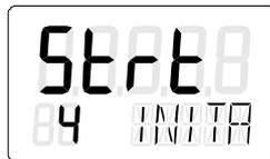
在自动初始化过程的五个初始化步骤中，定位器始终运行。从“RUN 1”到“RUN 5”的初始化步骤显示在显示屏的下面一行。初始化过程取决于所用的执行机构，最多占用 15 分钟。
