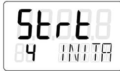
在自动初始化过程的五个初始化步骤中，定位器始终运行。从“RUN 1”到“RUN 5”的初始化步骤显示在显示屏的下面一行。初始化过程取决于所用的执行机构，最多占用 15 分钟。
