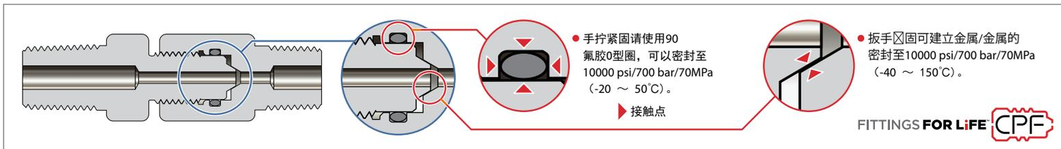
**注意：**如果您使用CPF快速测试连接件，就不必使用螺纹密封胶带。
