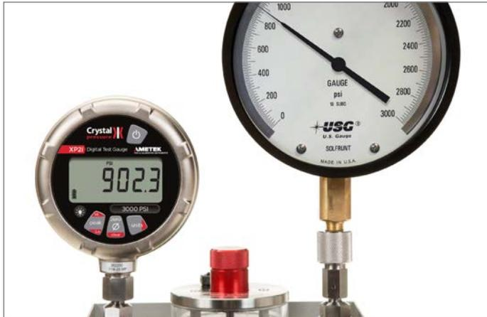
检查模拟压力表对照于参考压力仪显示值的精确度。
